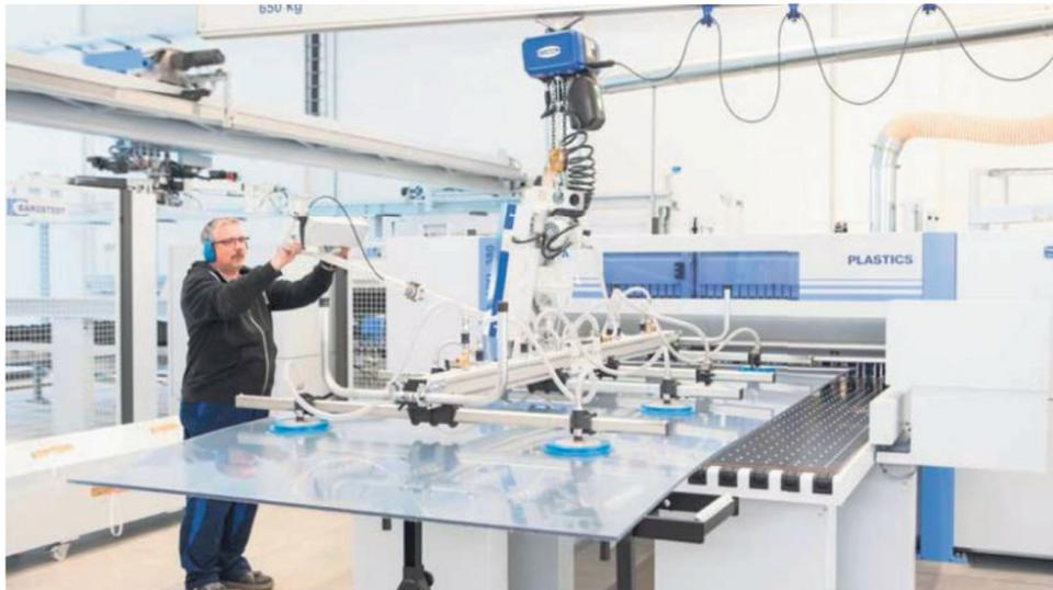
Blick in die Fertigung: Ein KRD-Mitarbeiter nimmt eine Polycarbonat-Platte per Vakuumspinne von einer Winkelsäge ab. Dieses Aggregat sägt die Platte an allen vier Seiten ohne menschliches Zutun zurecht; auch die Ablage kann computergesteuert erfolgen.
